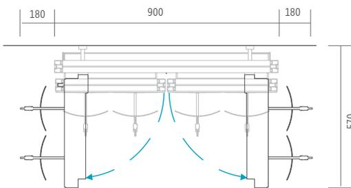
Durch die Zentrale Türöffnung kann das D3-Lager auch auf kleinstem Raum eingesetzt werden. Bei geöffneten Türen ist er nur 570 mm tief.
