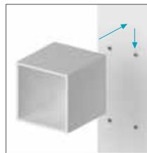
Schrauben leiten Strom und bieten LED-Beleuchtung sobald das Display ist montiert.
