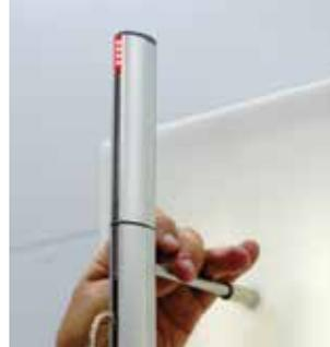
Elektromotor als Diebstahlsicherung. Das rote Licht am Motor schaltet sich automatisch ein, wenn die gesamte Stange entriegelt ist, aber auch bei unerlaubtem Kontakt mit der gesperrten Stange. In solchen Fällen wird der Audioalarm aktiviert, um einen möglichen Diebstahl zu verhindern.
